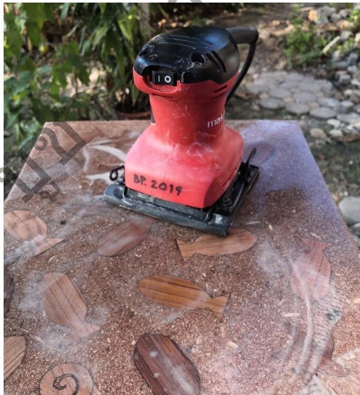
ภาพที่ 3.48 การขัดแต่งผิวด้วยเครื่องขัดกระดาษทราย ที่มา : บุษบา ผกากรอง, 24 เมษายน 2563
