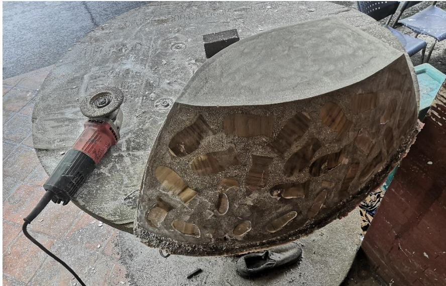
ภาพที่ 3.54 การขัดแต่งผิวด้วยเครื่องเจียร ที่มา : บุษบา ผกากรอง, 5 พฤษภาคม 2562
