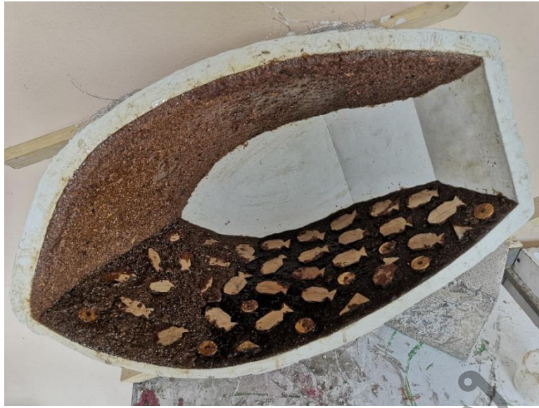
ภาพที่ 3.52 การสร้างหล่อด้วยวัสดุเรซินผสมขี้เลื่อยประกอบไม้ ที่มา : บุษบา ผกากรอง, 5 พฤษภาคม 2562
