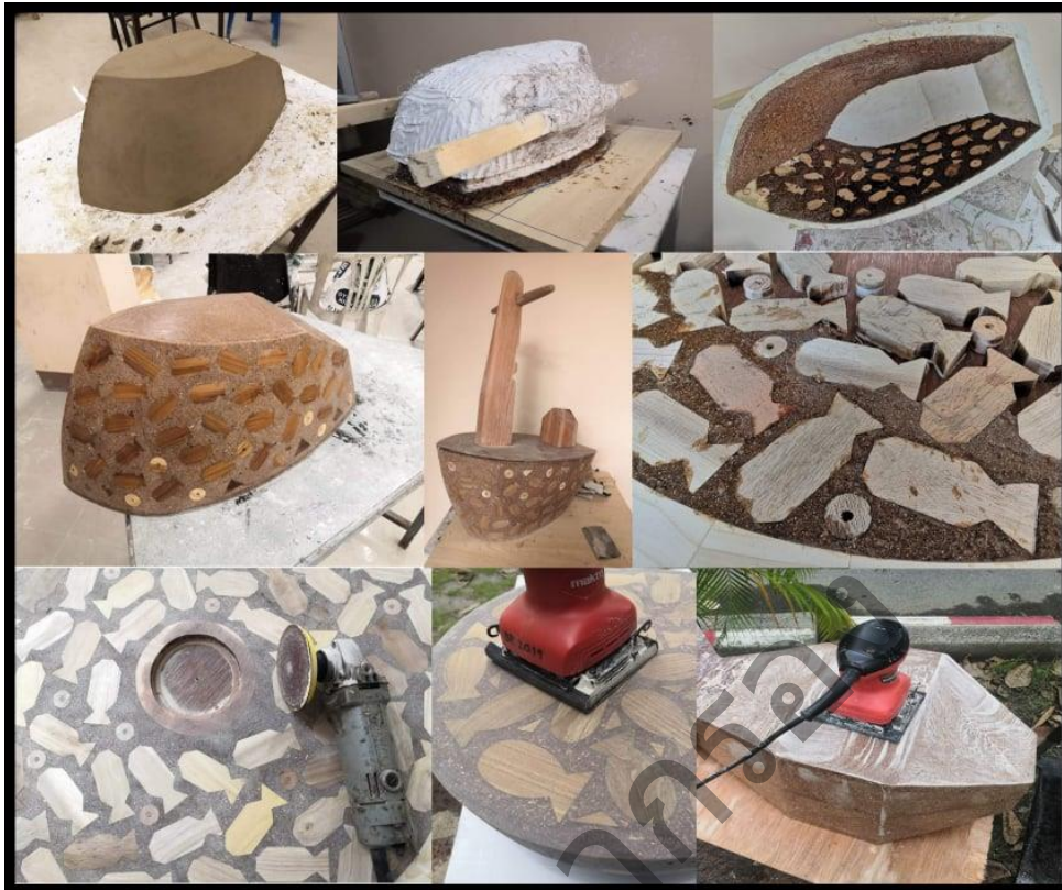
ภาพที่ 4.41 ลักษณะหลักการวิเคราะห์เทคนิคการสร้างรูปทรงด้วยการหล่อวัสดุเรซินผสมซีเมนต์ ที่มา : บุษบา ผกากรอง, 25 มิถุนายน 2564
