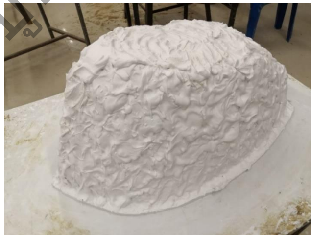
ภาพที่ 3.51 การสร้างแม่พิมพ์ปูนปลาสเตอร์ ที่มา : บุษบา ผกากรอง, 2 พฤษภาคม 2562
