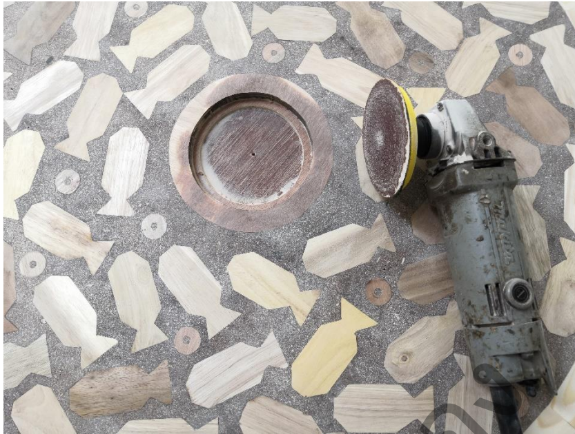
ภาพที่ 3.41 การเจียรขัดแต่งผิวแรกด้วยเครื่องเจียรของผลงาน 2 มิติ ที่มา : บุษบา ผกากรอง, 7 เมษายน 2562
