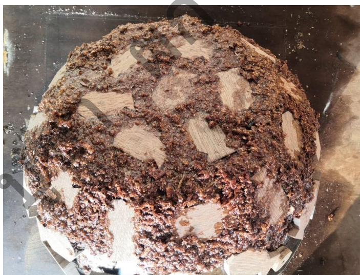
ภาพที่ 3.43 การใช้วัสดุสำเร็จรูปเป็นต้นแบบในการหล่อ ที่มา : บุษบา ผกากรอง, 5 สิงหาคม 2563
